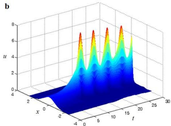
Рис. 3. Эволюция гауссова импульса огибающей в нестационарной среде при  $\alpha, f' = 0$ : а)  $\beta = 0.5, \gamma = -1 + 0.01 \sin 2\pi t$ ; б)  $\gamma = -1, \beta(t) = -0.5$  for  $t \leq 5$  and  $\beta(t) = 0.5(1 + 0.2 \sin 2\pi t)$  for  $t > 5$ ; случаи отрицательной нелинейности
