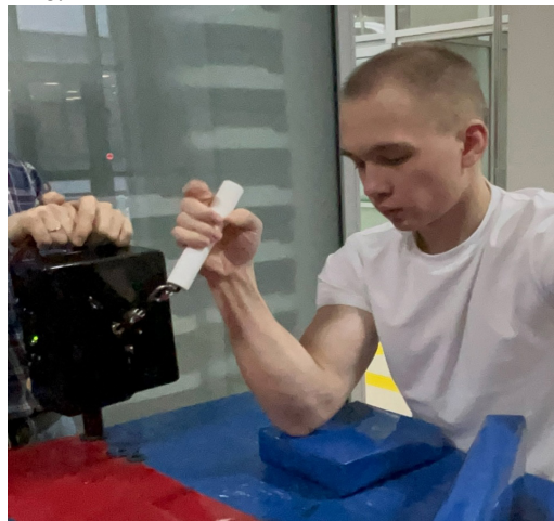
Рисунок 1 – Измерение с помощью портативного динамометрического устройства
