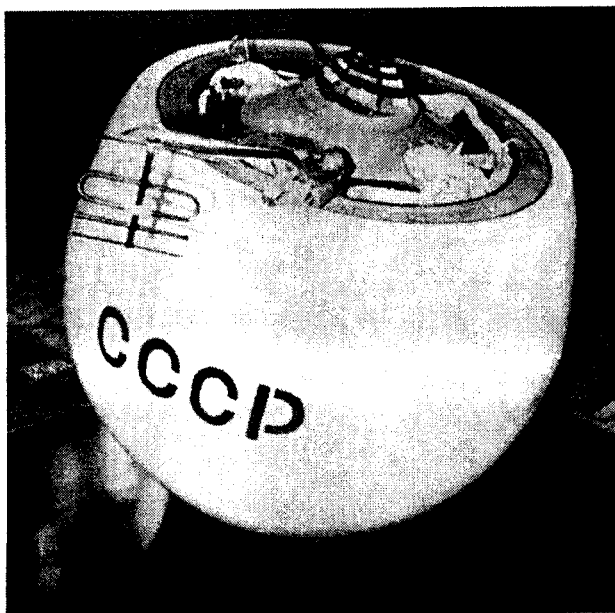
Рис. 4. Спускаемый аппарат АМС Венера-4 . Вошел в атмосферу Венеры 18.X.1967 г. Впервые космический аппарат провел измерения в атмосфере другой планеты.
