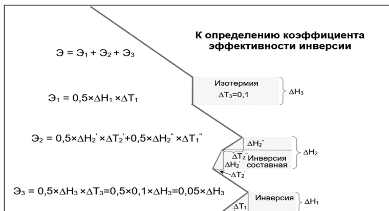
Рисунок 1 – К расчету коэффициента эффективности инверсии (изотермии)
