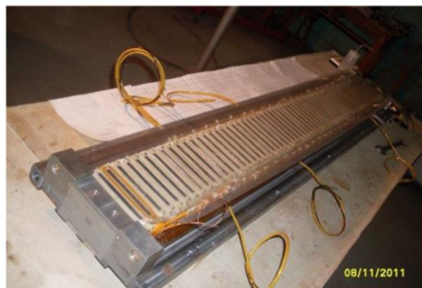
Рис. 3.16. Распределение магнитного поля в сверхпроводящем вигглере 4 Тл с нечетным числом основных полюсов (слева). Половина магнита вигглера с периодом 48 мм (справа)
