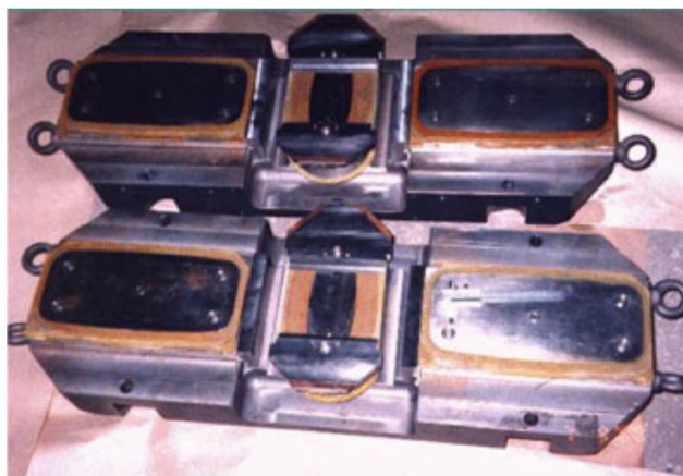
Рис. 3.18. Пример распределения магнитного поля в трехполюсном переключателе с полем в центральном полюсе 10 Тл. Показано поведение угла и координат внутри ондулятора для пучка с энергией 8 ГэВ (Spring-8) (слева). Две половинки 3-х полюсного переключателя перед окончательной сборкой (справа)
