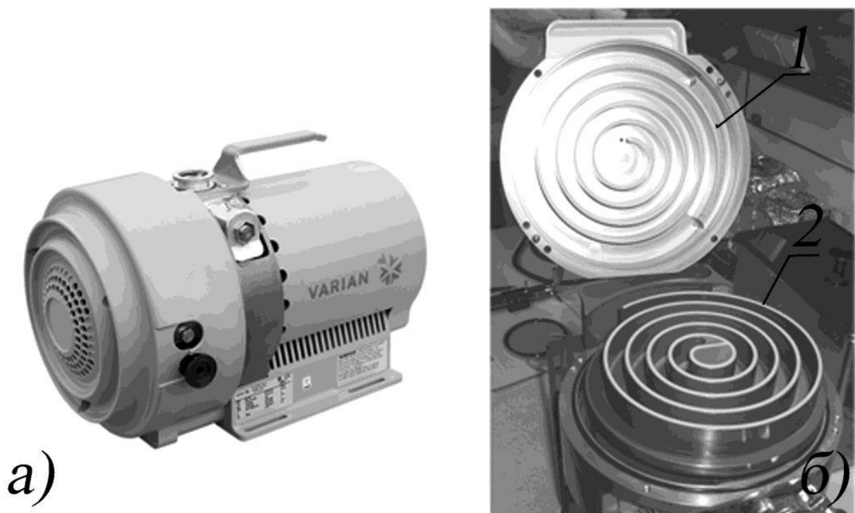
Рис. 2.5. Внешний (а) и внутренний (б) вид спирального насоса фирмы VarianSH-110 (скорость откачки 5,4 \text{ м}^3/\text{час} , предельное давление 5,0 \times 10^{-2} \text{ Торр} ): 1 – неподвижная спираль, 2 – подвижная спираль
