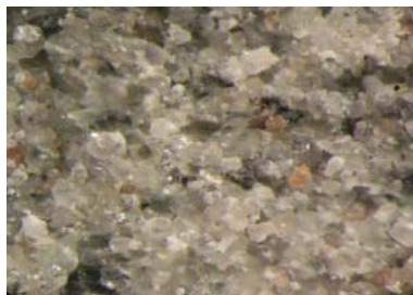
Рис. 3. Фотография бурового шлама в бинокулярном микроскопе
