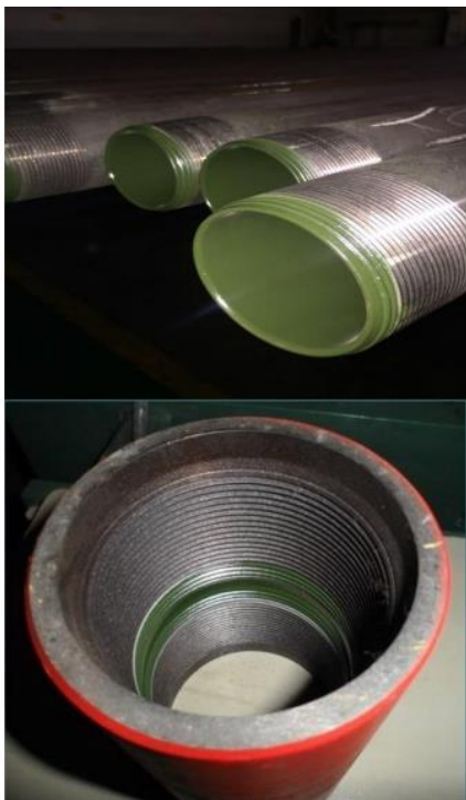
Рис. 2.4. Эффективность применения НКТ с покрытием на коррозионном фонде
