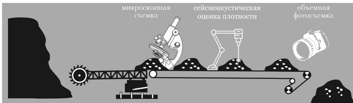
Рис. 2. Эвристический алгоритм детерминации качества угля на основании данных с камер
