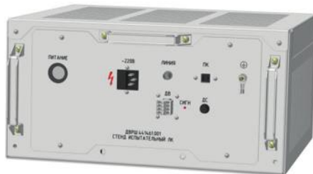
Рисунок 1 – Внешний вид испытательного стенда для испытания ЛК
