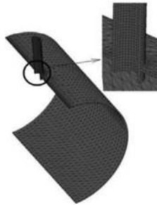
Рис.2 Сетка соединения штуцера с обечайкой
