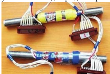
Рис.4 Образцы с датчиками тензометрии
