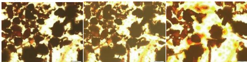
Рисунок 3 – Микрофотографии целлюлозы, модифицированной азонолом при 140°С, 180°С и 200°С
