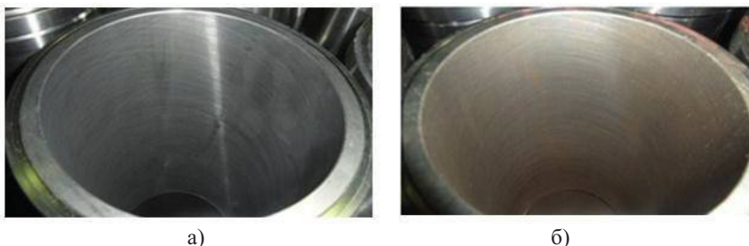
Рис.3 Гильза до (а) и после (б) латунирования
