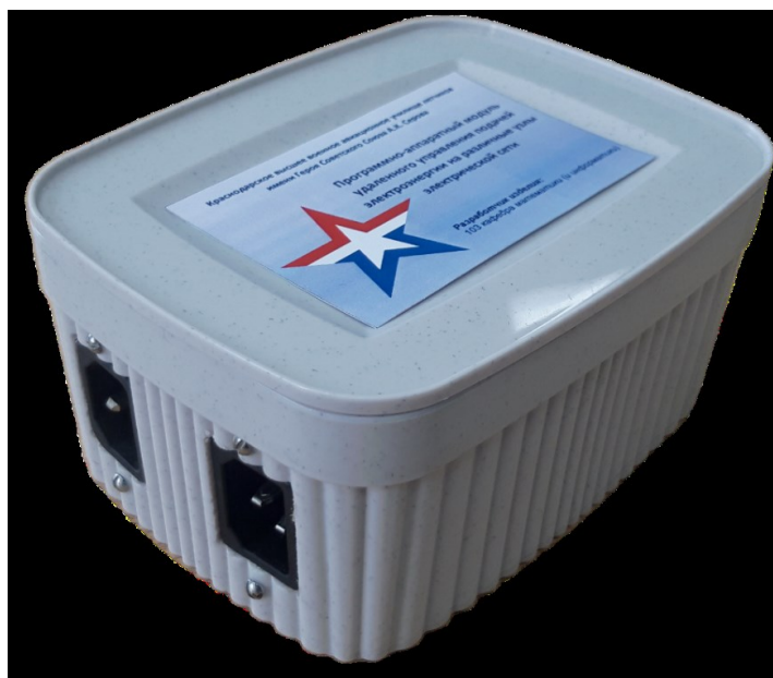
Рис. 2. – Устройство удаленного управления подачей электроэнергии
