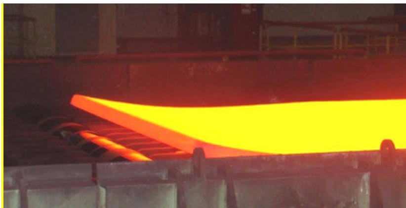
Рис. 1. Дефект «лыжа» при прокатке на стане 5000 ОАО «ММК»
