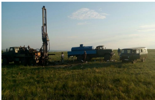
Рисунок 1 – Буровая установка УРБ-2А2 на базе автомобиля УРАЛ-4320 и водовозка на базе автомобиля ЗИЛ-131
