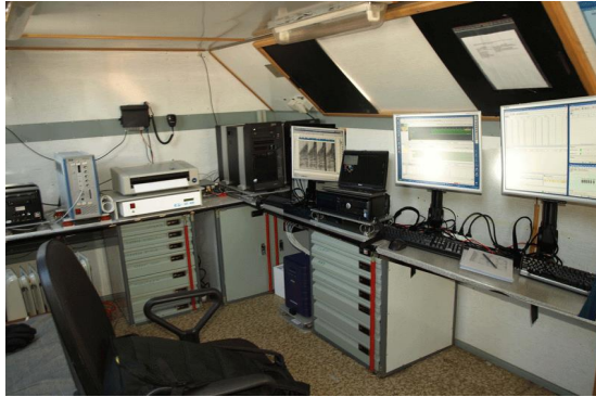
Рисунок 2 – Телеметрический комплекс Sercel-428XL
