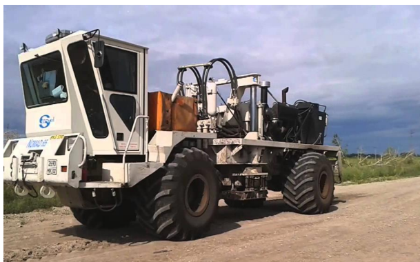
Рисунок 1 – Вибрационная установка NOMAD-65
