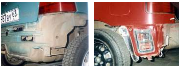
Рисунок 1.17 - Расположение вытяжных отверстий и клапанов на автомобилях «Renault-Twingo» (а), «Ford-Escort» (б)
