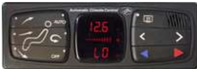
Рисунок 1.6 - Система автоматического климат-контроля, разработанная московской фирмой «Алькор», для установки в автомобиль «Волга»
