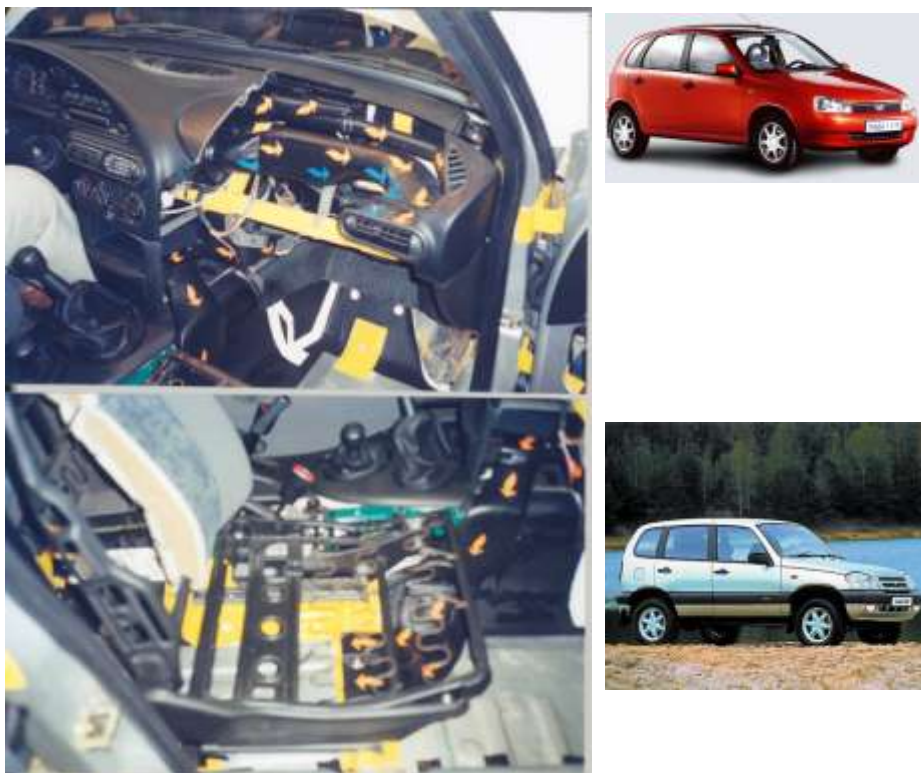
Рисунок 1.9 - Расположение системы вентиляции, отопления и кондиционирования с изображением, в виде стрелок, распределения потоков воздуха из панели приборов автомобиля ВАЗ-1119 «Калина» и ВАЗ-2123 «Шеви-Нива»
