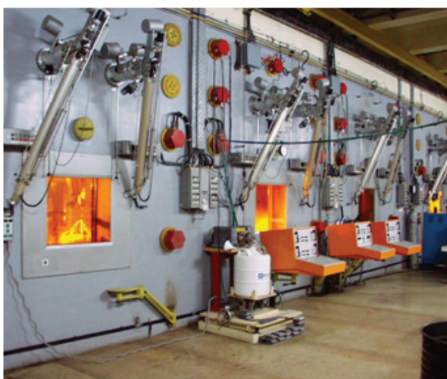
Рис. 2. Схема установки робота-манипулятора в системе «горячий» бокс защитной камеры АЭС в коробе горячей камеры АЭС
