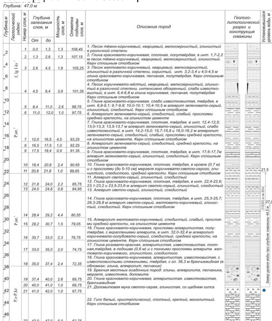
Рис. 3 Геолого-литологическая колонка инженерно-геологической скважины.
