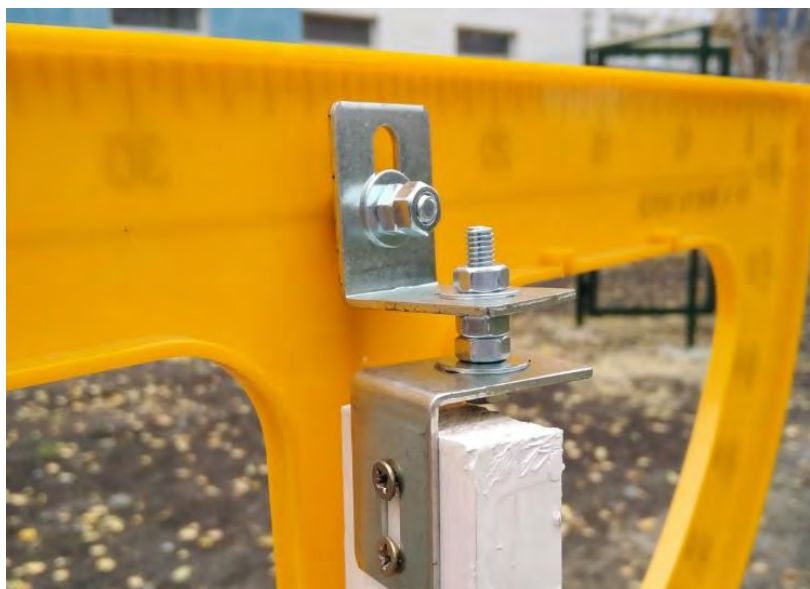
Рисунок 3 – Наклонно-поворотный механизм эклиметра
