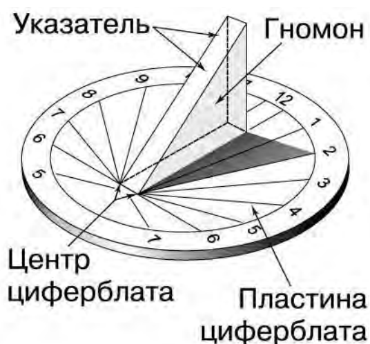
Рисунок 4 – Схема устройства солнечных часов с гномоном
