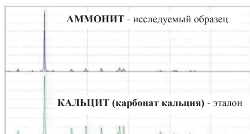
Рисунок 1 – Результаты рентгенофазового анализа ростра белемнита (анализ проведён во ФГУП «РФЯЦ – ВНИИЭФ»)
