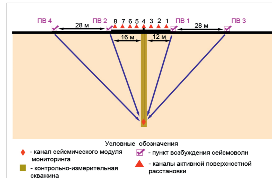
▲ Рис. 2. Система наблюдения при наземно-скважинной съемке.
