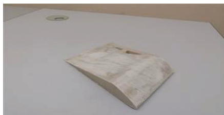
Рис. 4. Сегмент каркаса с припавленной обшивкой
