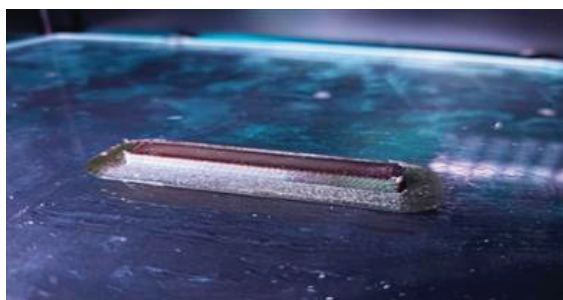
Рис. 1. Брусок для испытаний на термомеханические характеристики
