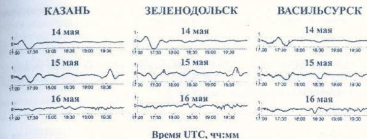
Рис. 2. Вариации ПЭС для спутника GPS №29. Режим работы передатчиков стэнда Сура: – 7 минут напрев, 3 минуты пауза. Время работы стэнда «Сура»: 13 мая – 19:00 UTC – 20:00 UTC; 14 мая – 19:00 UTC – 19:50 UTC; 16 мая – 18:50 UTC – 19:40 UTC.
