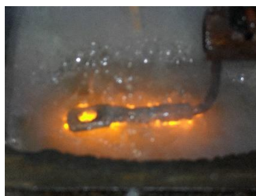
Рис. 2. Образование парогазовой оболочки электрическом разряде, горящим между электролитом и пористым слоем при атмосферном давлении
