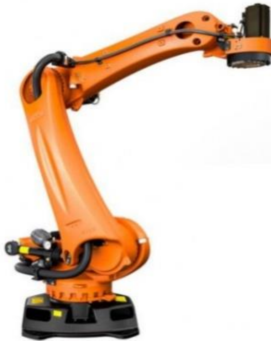
Рисунок 4 – Робот манипулятор KUKA KR QUANTEC PA arctic
