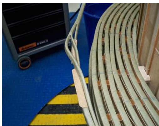
Рисунок 1 – Намотка обмотки СМИТ
