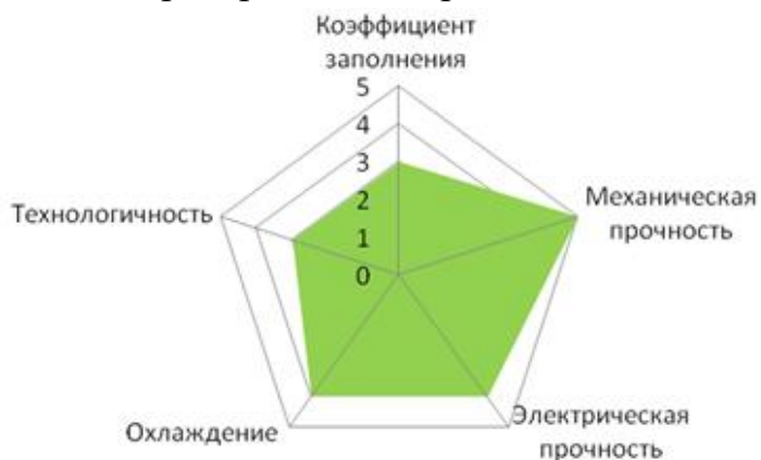
Рисунок 3 – Качественные критерии цилиндрической многослойной обмотки
