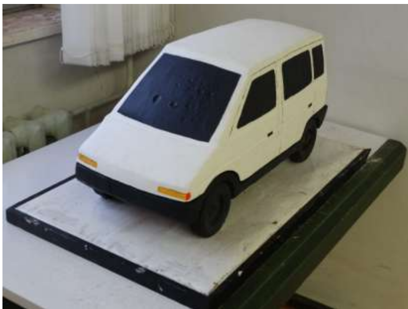
Рис. 5. Поисковый макет внешних форм легкового автомобиля
