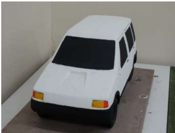
Рис. 15. Поиск композиционного решения с применением масштабного макета
