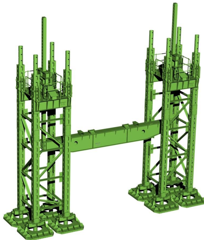
Рис. 26. Общий вид башенной подъёмной опоры
