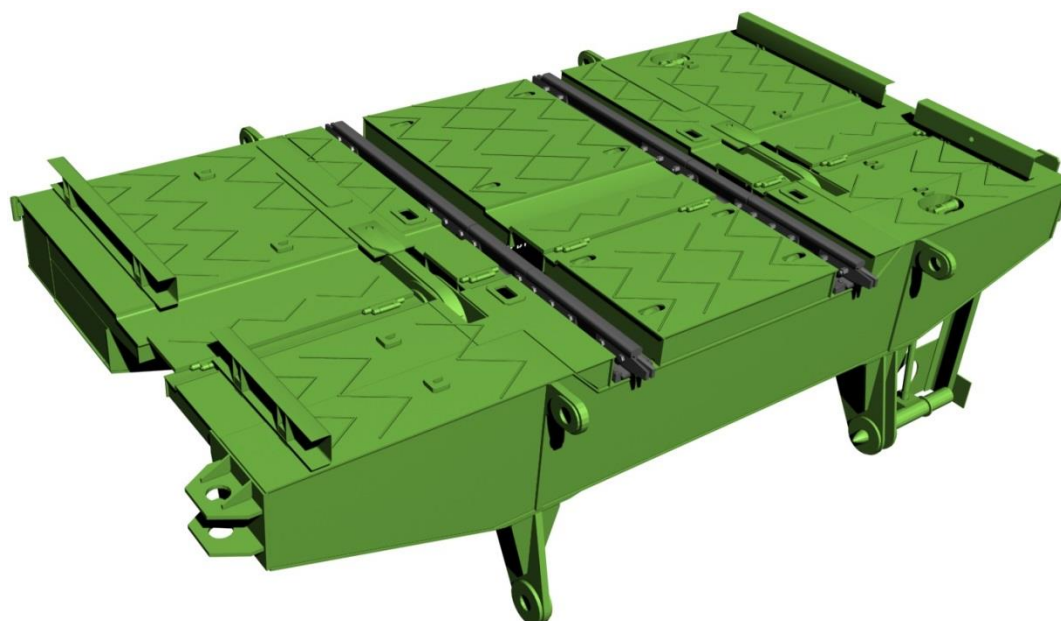
Рис. 21. Шарнирный компенсационный стык переходной и береговой частей моста (общий вид)
