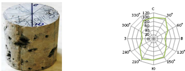
Рис.2. Профиль изменения абсолютной горизонтальной газопроницаемости образца керна с сохранённым диаметром
