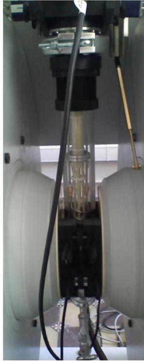
**Рисунок 4.4** Диэлектрический резонатор с блоком азотного проточного криостата.
