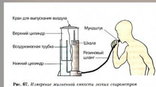
Рис. 67. Измерение жизненной емкости легких спирометром
