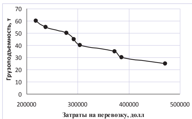
Рисунок 2 – Зависимость затрат на перевозку от грузоподъемности дирижабля
