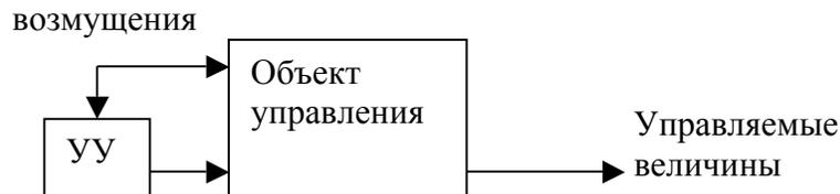
Схема замкнутой управляемой системы:
