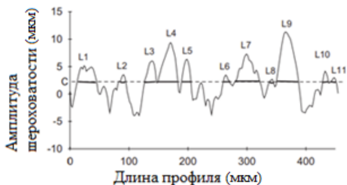
Рис.1 – Профиль шероховатости и описание метода построения кривой Эбботта согласно нормам DIN 4776 или ISO 13565.
