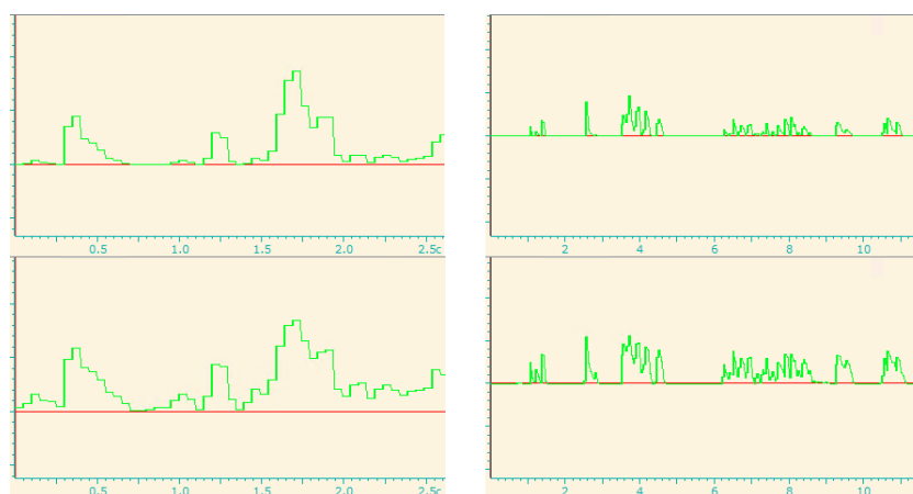
Рис.2. Сравнение использования суммы квадратов (верхний ряд) и суммы модулей (нижний ряд) значений сигналов в формуле подсчета энергии
