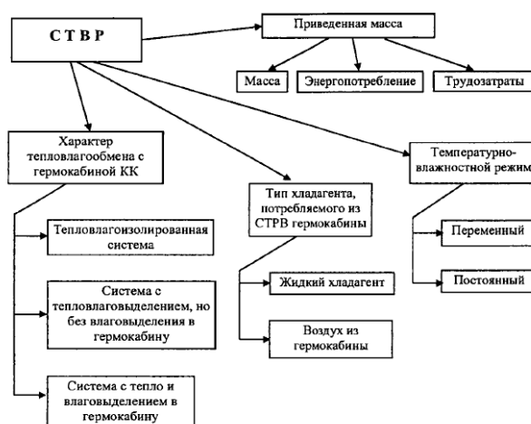
Рисунок 1 – Основные характеристики системы терморегулирования космических оранжерей [6]
