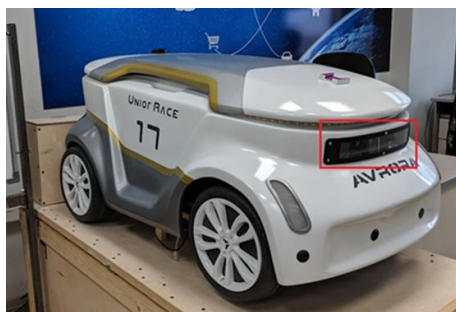
Рис. 1. Робот Avrora Unior. Красным прямоугольником отмечен сенсор Microsoft Kinect.
