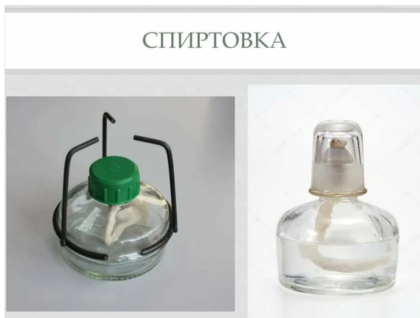
Рис. 2. Устройство нагревательного прибора (спиртовки)
