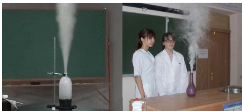
Рис. 9. Экзотермическая реакция разложения 30 %-ной перекиси водорода под действием катализатора – диоксида марганца
