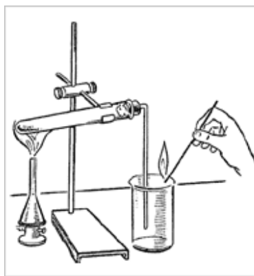
Рис. 6. Получение из \text{KMnO}_4 кислорода и собирание его методом вытеснения воздуха. Обнаружение кислорода тлеющей лучинкой
