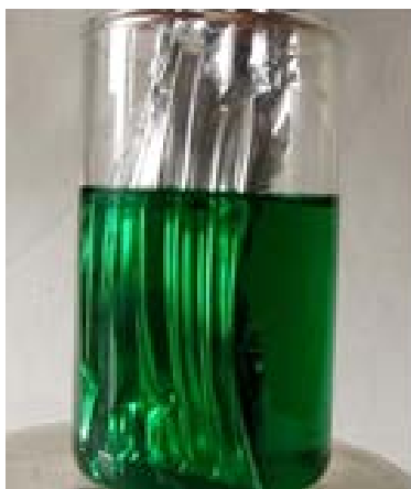
Рис. 3. Получение водорода реакцией алюминия со смесью сульфата меди (II) и хлорида натрия
