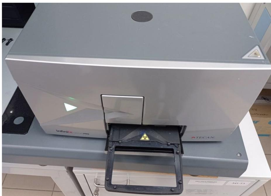
**Рис. 6.** Держатель для планшетов устройства «Tecan M200 Pro» в выдвинутом положении
