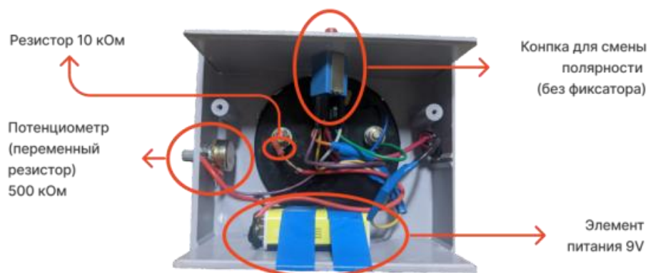
Рисунок 4 - Вид сверху без крышки
