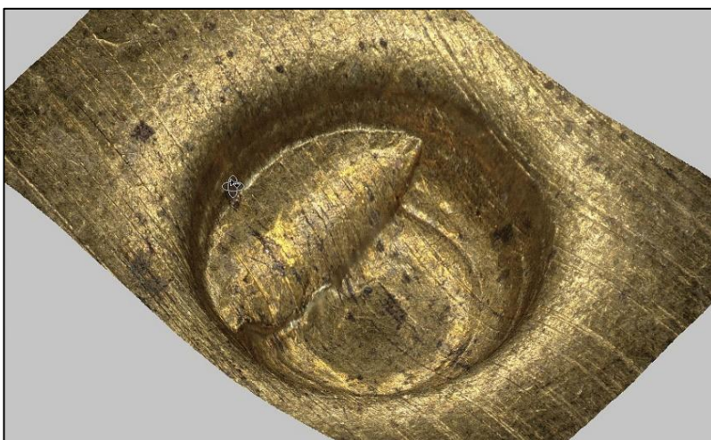
Рис. 5. 3D-модель следа бойка ударника на капсюле гильзы (9 мм пистолет ИЖ-71)
