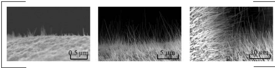
Рис. 1 Кинетика роста вискеро́в при отжиге на воздухе медных слоев при 400° С: а – 1 мин, б – 30 мин, в – 4 часа
