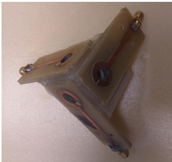
Рис. 2. Система 3-х взаимно перпендикулярных пробников.
