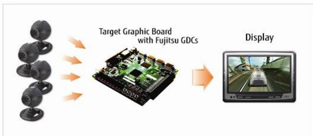
Рис. 5. Аппаратно-программный комплекс кругового обзора Fujitsu 360° Wrap-Around VideoImaging Technology [10]
