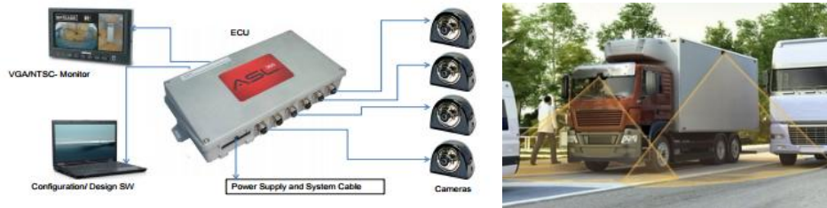
Рис. 3. Система кругового обзора Continental ProViu ASL360 [10]
