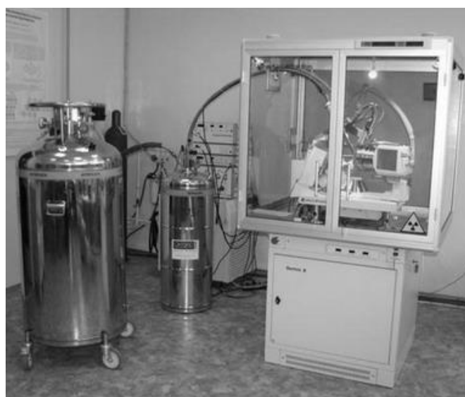
Рис. 3.2. Внешний вид рентгеновского дифрактометра Gemini-R
