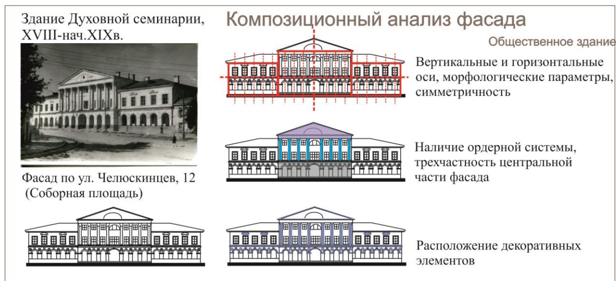
Рис. 3. Композиционный анализ фасада общественного здания
