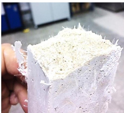
Рис. 1. Испытания стеклофибробетона (определение предела прочности на сжатие)
