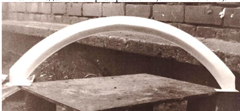
Рис. 2. Модель №1. Арка пролетом 2,0 м и высотой 0,3 м
