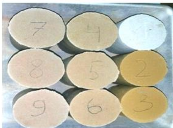
Рис. 4. Спрессованные образцы цилиндры с ХВО: 1-контрольный состав, 2, 3 - с желтым пигментом, 4, 5 – 5% ХВО, 6, 7 – 10% ХВО, 8, 9 – 15% ХВО
