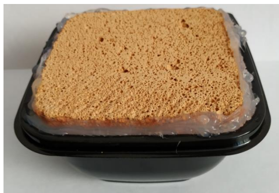
Рис. 3 Образец газокерамики для определения коэффициента паропроницаемости
