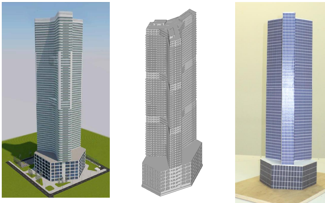
Рис. 2. Проект 65-этажного гостиничного комплекса, компьютерная 3D-модель и макет высотного здания для испытаний в аэродинамической трубе.
