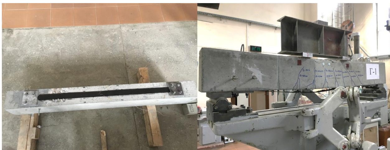
Рис.1. Лабораторные образцы: а) Образец после преднапряжения; б) Образец после испытания
