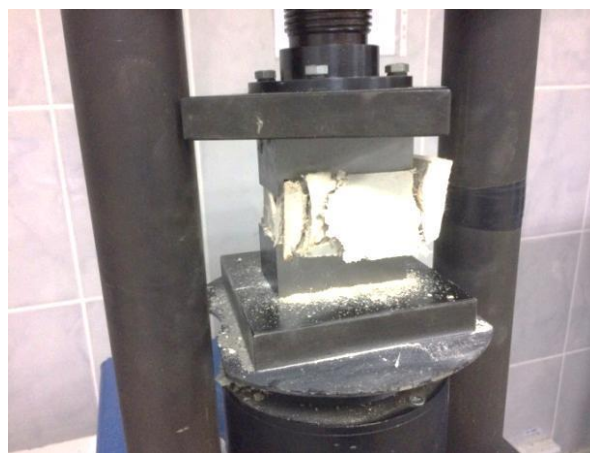
Рис. 1. Испытания стеклофибробетона (определение предела прочности на сжатие)
