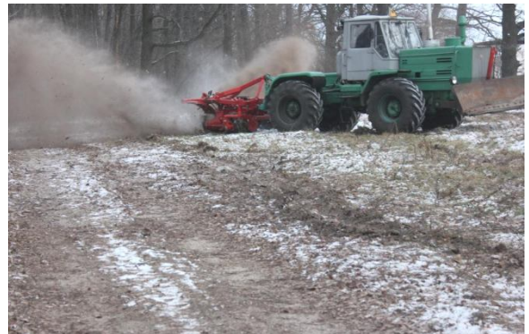
Рисунок 6 – Пожарный грунтомет-полосопрокладыватель ВГЛТА:
