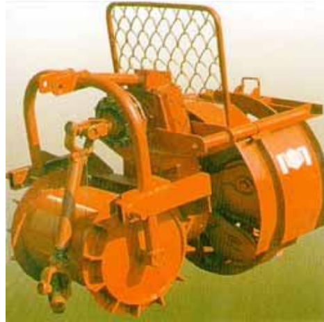
Рисунок 3 – Агрегат лесопожарный фрезерный АЛФ-10
