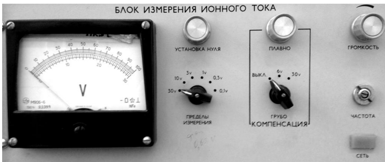
Рисунок 9 - Панель управления блока измерения ионного тока.
