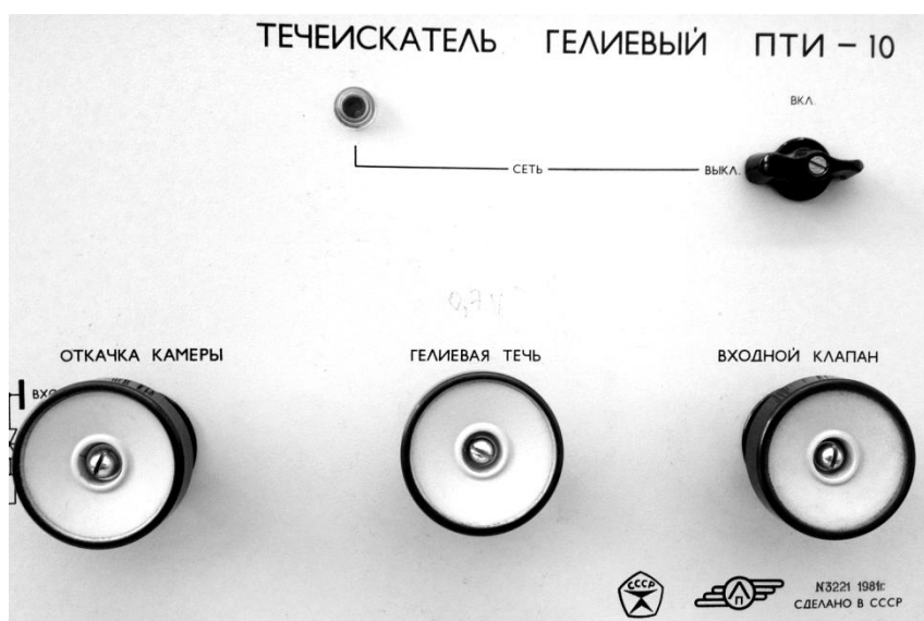
Рисунок 8 - Вакуумные вентили на панели управления.
