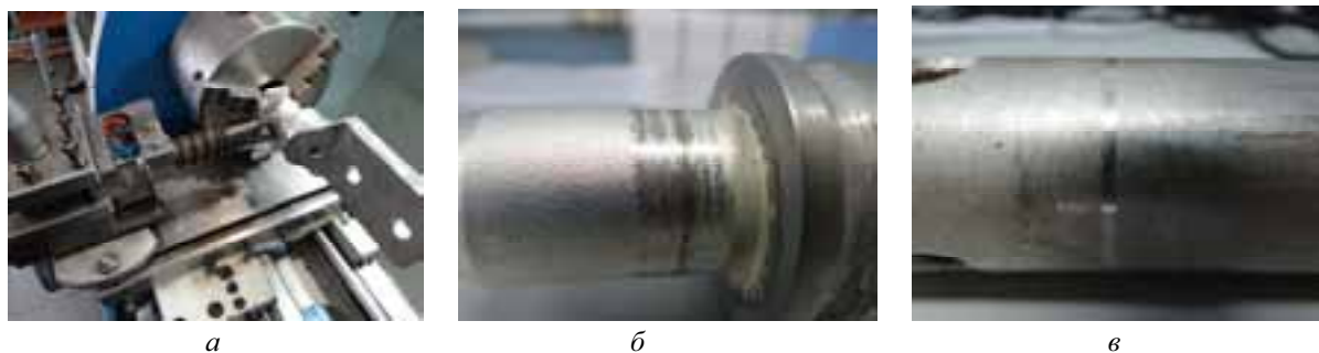
Рис. 2. Испытания деталей многослойными покрытиями: вид установки для испытаний на циклическую стойкость (а); вид покрытия, сформированного с помощью установки «Димет» (медная подложка) после испытаний (б); вид покрытия, сформированного с помощью установки «Дракон» (медная подложка) после испытаний (в)
