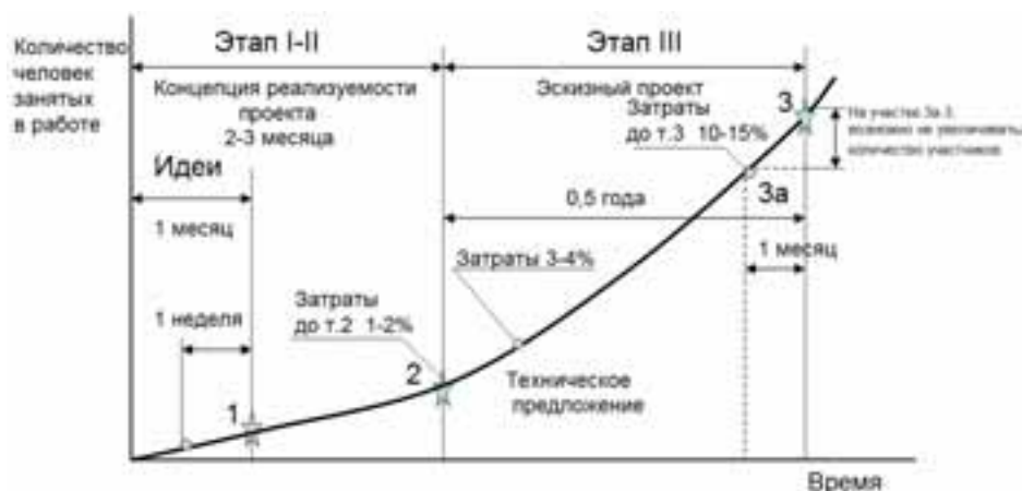
Рис. 2. Этапы проектирования камеры сгорания
