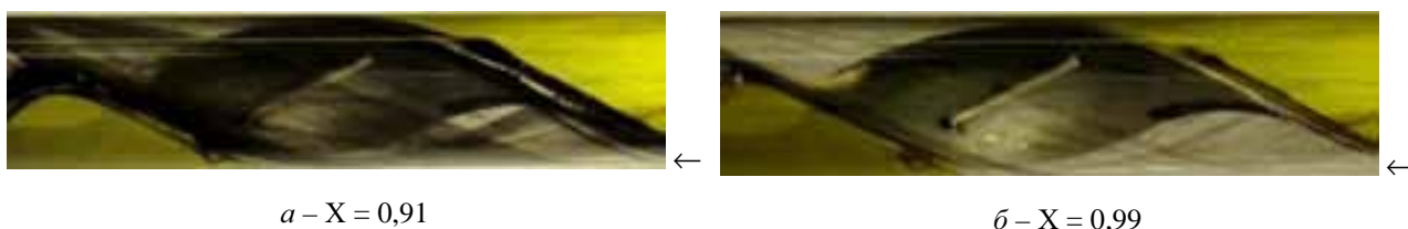
Рис. 11. Фотографии двухфазных течений в трубе со скрученной лентой с ребрами на ее поверхности, расположенными под углом к оси ленты против направления ее скручивания (жидкость подкрашена темной краской, половина канала заглушена): G = 14,5 г/с, p = 0,15 МПа, s/d = 3 , высота ребер 1 мм, шаг между ребрами 18 мм
