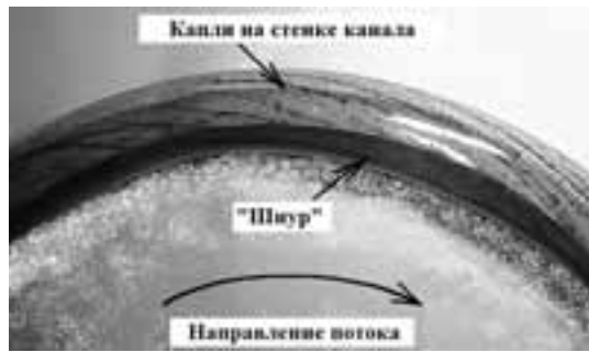
Рис. 2. Фотография дисперсного режима течения в змеевиковом канале (вид параллельно оси навивки змеевика)
