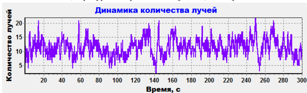
Рис.3. Изменение численности парциальных лучей при движении со скоростью V = 30 м/с
