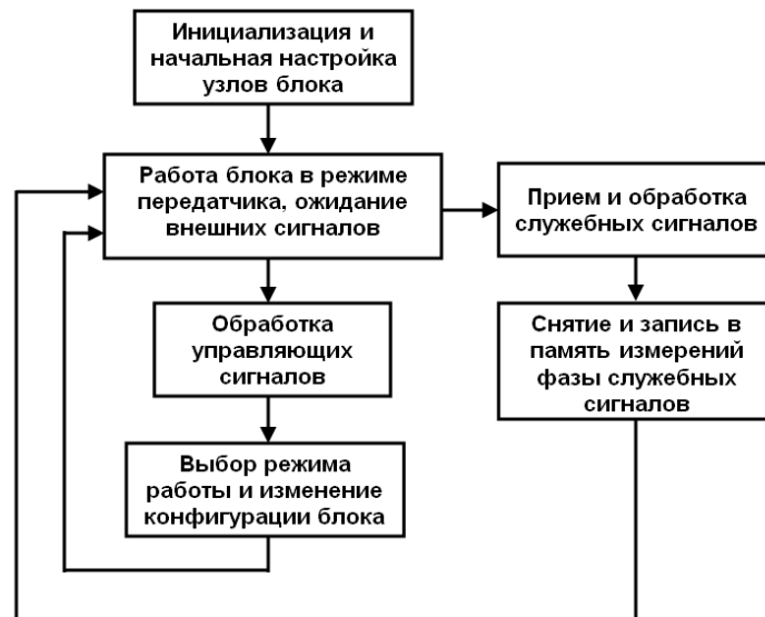
Рис. 2. Блок-схема алгоритма работы приемопередающего блока
