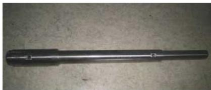
Рис. 2. Стандартный испытательный цилиндр диаметром 7,62 мм
