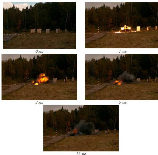
Рис. 1. Последовательность кадров скоростной видеोगраммы взрыва макета БЧ
