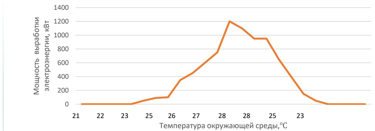
Рис. 2. Суточная прогнозируемая выработка фотоэлектрической установки при отклонении от средней температуры окружающей среды
