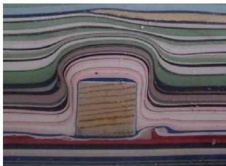
Рис. 3. Образец, армированный древесным материалом
