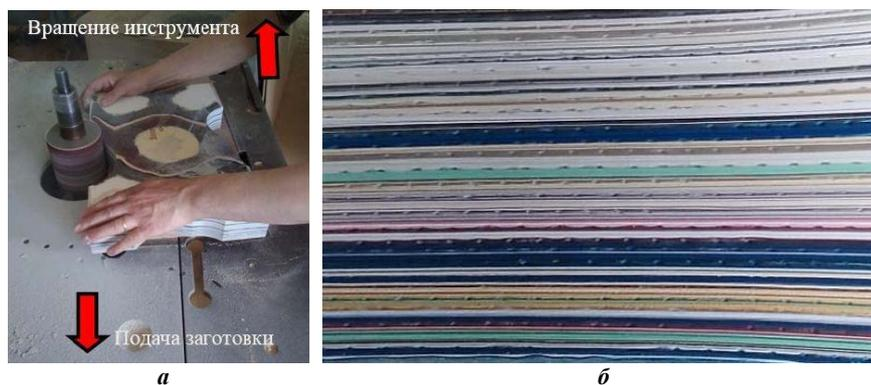
**Рис. 8. Абразивная обработка матричного композитного материала: а – основные движения при обработке; б – несрезаемость армирующего материала**
