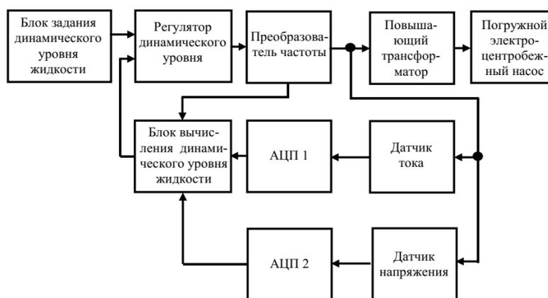
Рис. 2. Функциональная схема предлагаемой системы управления погружным электроцентробежным насосом
