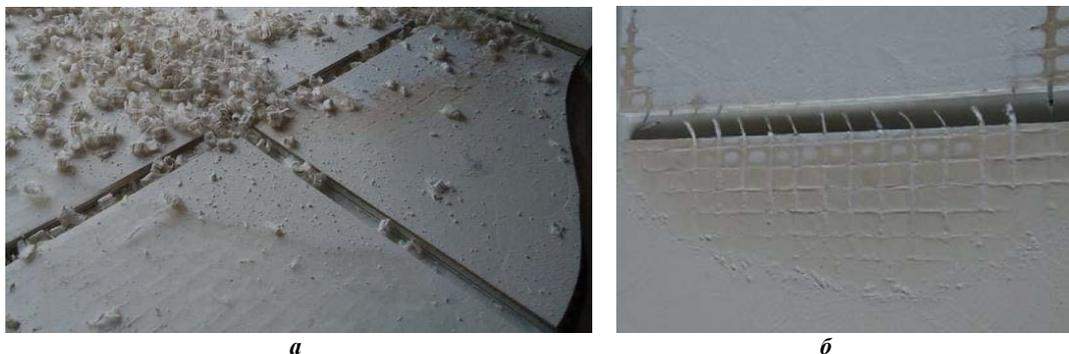
**Рис. 7. Обработка армирующего материала: а – несрезаемость армирующего материала; б – поверхность с полностью срезанным армирующим материалом**
