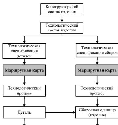
Рис. 2. Последовательность проектирования ТП
