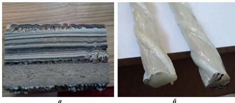
**Рис. 1. Композитные материалы на основе полимеров: а – полимер в виде фоновых материалов; б – полимер в виде армирующего наполнения**
