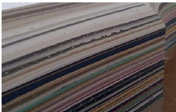
Рис. 5. Поверхность после обработки с частотой вращения шпинделя 9000 об/мин
