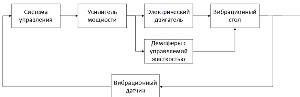
Рис. 4. Функциональная схема вибростенда с коррекцией амплитуды вибрации
