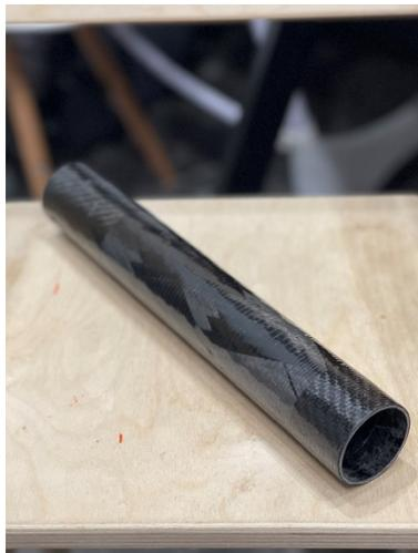
*Натурный образец композиционного вала, предназначенный для испытаний*
