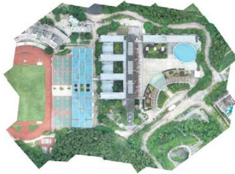
Рис. 3. Ортофотоплан с квадрокоптера, построенный из 64 изображений [9]
