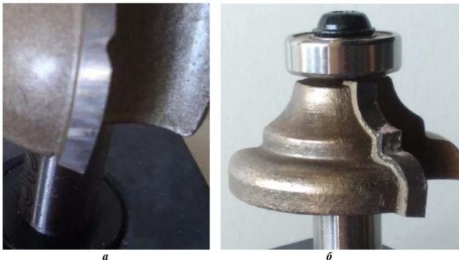
Рис. 2. Дефекты режущего инструмента после обработки: а – нарост; б – скалывание
