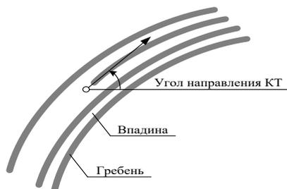
Рис. 3. Расположение и направление контрольной точки окончания гребня (закодированной в качестве точки бифуркации)
