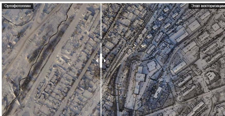
Рис. 6. Ортофотоплан с этапом векторизации
