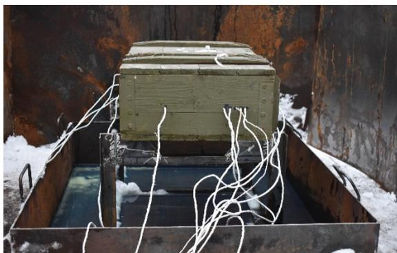
боеприпас в таре на установке быстрого нагрева до проведения испытания
