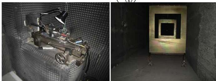
Рис. 3. Измерение давления и скорости пули с помощью пьезоэлектрического преобразователя
