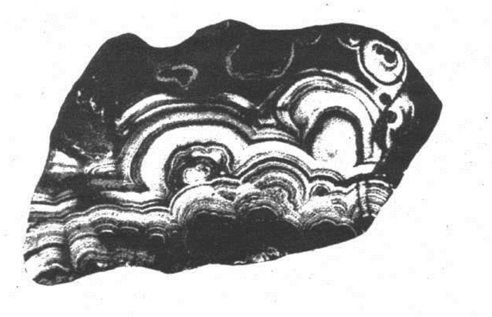
Рис. 4. Колломорфная и почковидная текстура коллоидных агрегатов малахита. Структура агрегата концентрически-зональная. Месторождение Высокогорское, Урал. Полированный штуф
