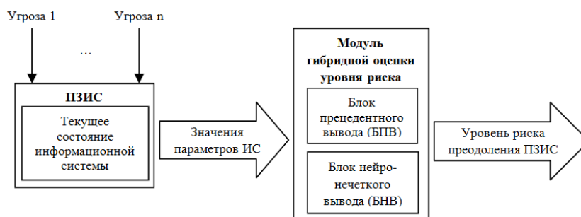
Рис.2. Модель настройки ПЗИС с использованием гибридного модуля оценки уровня риска
