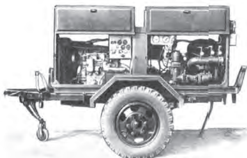
Рисунок - 1 Мотонасосная установка для перекачки горючего – 80
