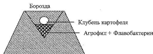
Рис. 1. Схема внесения смеси биопрепаратов Агрофил + Флавобактерин в приготовленные борозды
