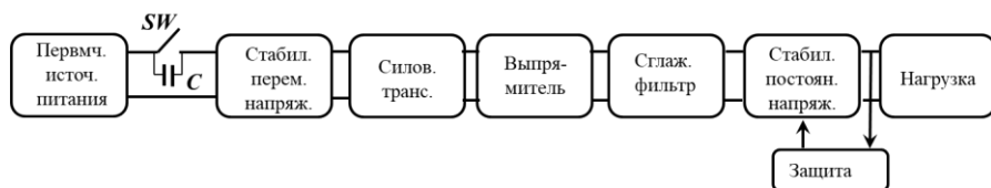
Рис. 5.1. Структурная схема источника питания.
