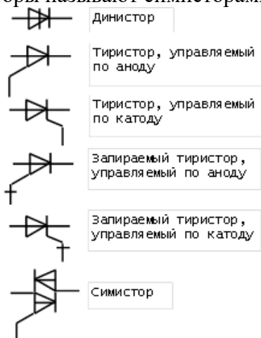
Рис. 1.56. Условные графические изображения тиристоров на схемах.
