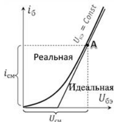
Рис.2.5. Реальная и идеальная входная характеристика транзистора.
