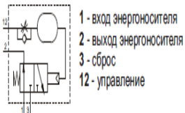
Рис.9.9. Пневматический таймер нормально открытый.
